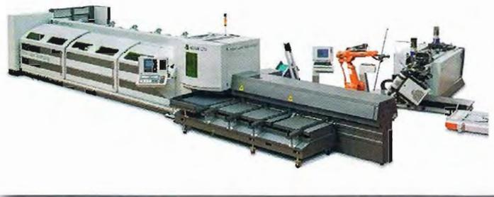
Un ejemplo de estos conceptos se puede observar en la isla operativa compuesta por una máquina de corte de tubo, la nueva Lasertube LT5 con láser de fibra de 2KW, conectada a una curvadora E-TURN por medio de un robot antropomórfico que garantiza la sincronización entre las dos fases de trabajo, desde el diseño asistido por ordenador (CAD), donde es posible importar diseños de piezas cortadas con láser y curvadas, hasta la gestión de la producción de acuerdo con un modelo de gestión tipo CIM.
