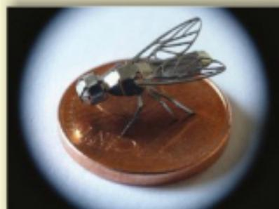
Amostras de peças de precisão dobradas na BT-150. No detalhe, a representação de um inseto articulado em metal, dobrado a partir de blâques cortadas a laser e montado por encaixe. Um vídeo que demonstra a sua execução pode ser visto no endereço eletrônico da empresa, no link [www.blech-tec.com/schwenkbiegemaschine/video.html](http://www.blech-tec.com/schwenkbiegemaschine/video.html).
