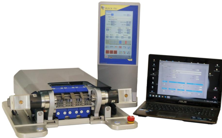
Durch sektionierte Standardwerkzeuge können mit der BT-150 selbst komplexe Biegeteile sofort ohne weitere Werkzeugkosten hergestellt werden. Die Teile werden nach sehr kurzen Rüstzeiten wiederholgenau in einer beeindruckenden Präzision (0,01 mm/0,1°) gebogen. Bild: Blech-Tec
