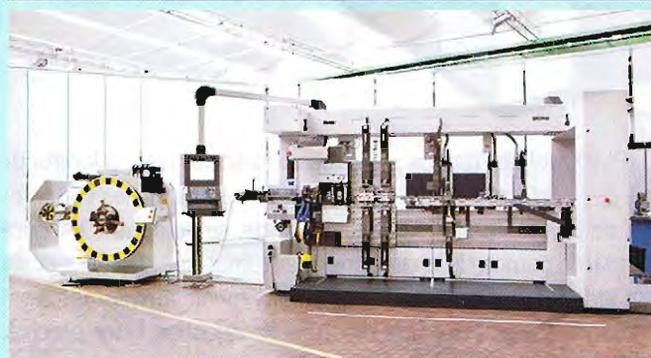
Le système de fabrication et d'assemblage à commande numérique BIMERIC BM 3000, en version standard sera exposé. Cette version standard permet déjà de couvrir avec grande efficacité une très vaste gamme d'applications - même en petites séries - sans qu'il faille modifier la configuration de la machine pour changer de produit.
